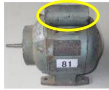
交流電源を使用する比較的大型のモーターに部品として取り付けられている起動用コンデンサーにPCB汚染の可能性あり。絶縁油が使用されていない**乾式コンデンサー、フィルムコンデンサー、アルミ電解コンデンサー**等にはPCB汚染の可能性はない。
