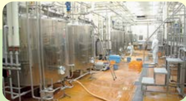
一つのタンクで2トンの生乳を加工できます
