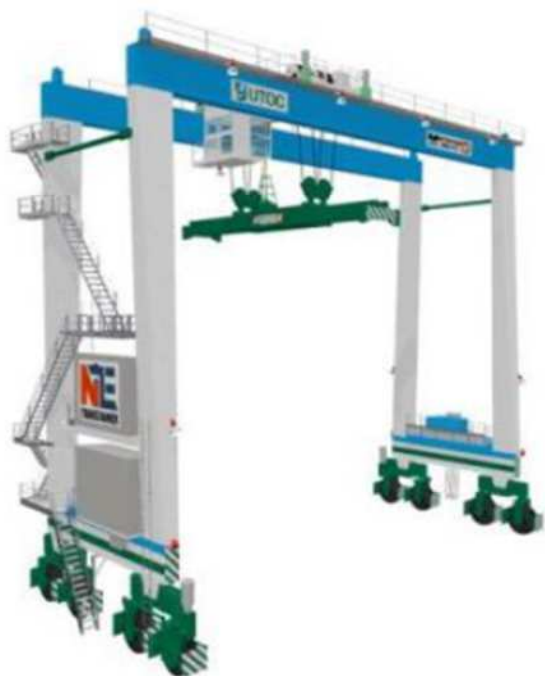
脱炭素化型タイヤ式トランスファークレーンのイメージ図
