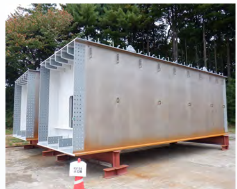
【橋梁上部工工場製作中】
