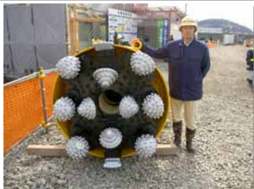
最大礫径330mm対応 改良型先導体
