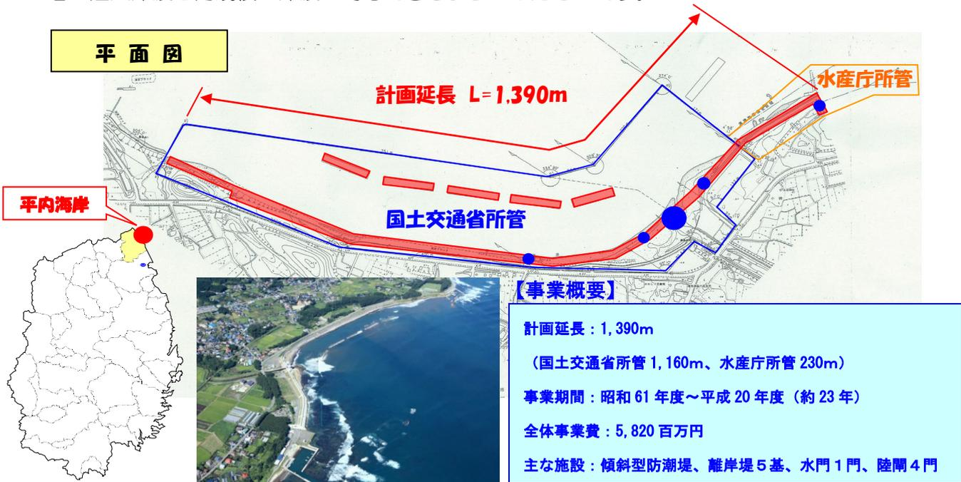
本事業では、防潮堤・水門による津波対策のほか、大船渡港に次いで**県内2箇所目となる「津波・高潮防災ステーション」**を久慈消防署種市分署に設置し、津波発生時には水門及び道路陸閘を遠隔操作で迅速に閉鎖出来るようにしました（久慈地方振興局土木部に監視局を設置）。
