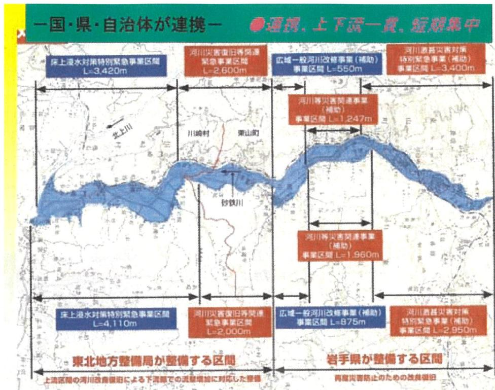
何故、このような被害を受けたかといいますと、堤防がない箇所があったことと洪水を流せるだけの河川断面がなかったためでしたので、今回の事業では堤防が無い箇所に堤防を築くことと、洪水を流せるように河川断面を大きくするための掘削（河道掘削）を行い、平成14年7月の台風6号のときと同じ規模の洪水に対して、二度と災害が起こらないようにするものです。また、堤防を守るために護岸工を施工することとしています。
