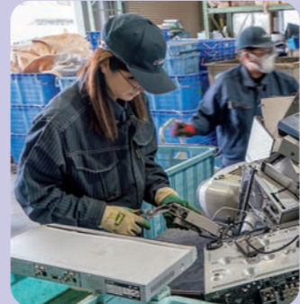
細かい気づきや丁寧な作業で、電子機器類からバッテリーなどの破碎不適物を除去
