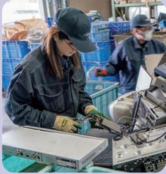
細かい気づきや丁寧な作業で、電子機器類からバッテリーなどの破碎不適物を除去
