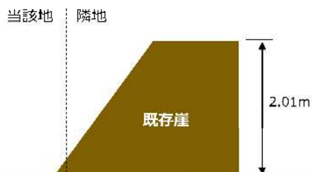
図-3 宅造区域で許可が必要となるイメージ（崖下切土）
