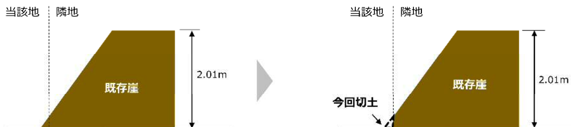
図－3 宅造区域で許可が必要となるイメージ（崖下切土）
