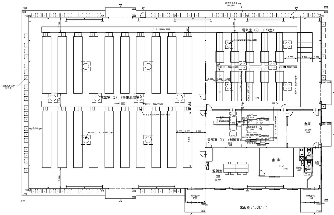
高森高原風力発電所 変電所平面図 S=1/200
