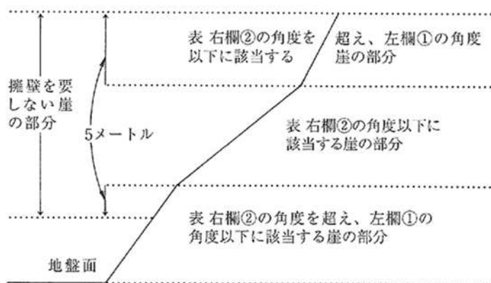
図 2-2 擁壁を要しない崖又は崖の部分 (2)
