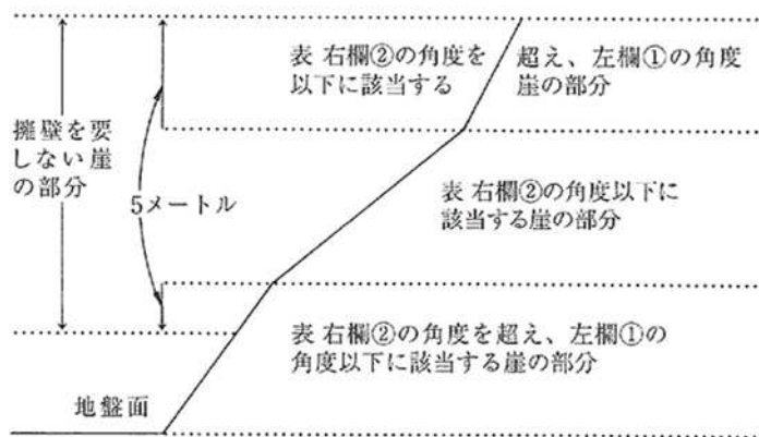
図 2-2 擁壁を要しない崖又は崖の部分 (2)
