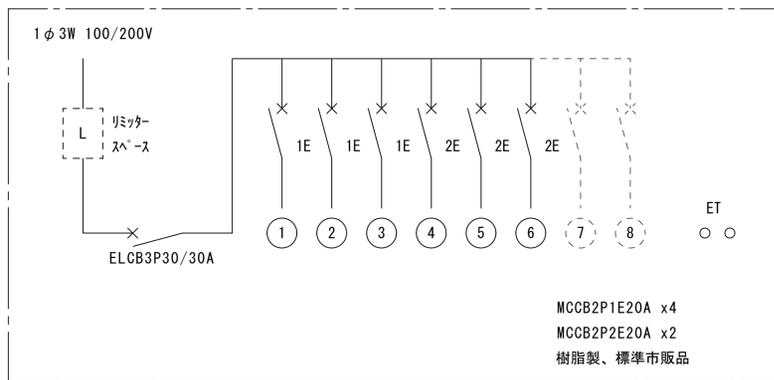
L-3 各戸分電盤結線図 x 12面
