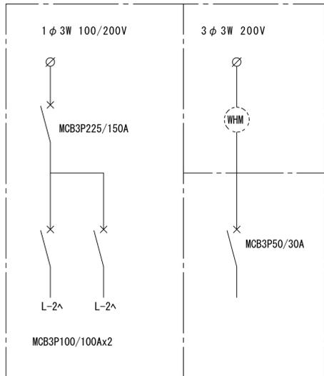
PL-1 引込開閉器盤 屋外壁掛型
