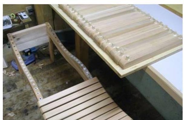
座面と脚部は「だぼ継ぎ」により接着
