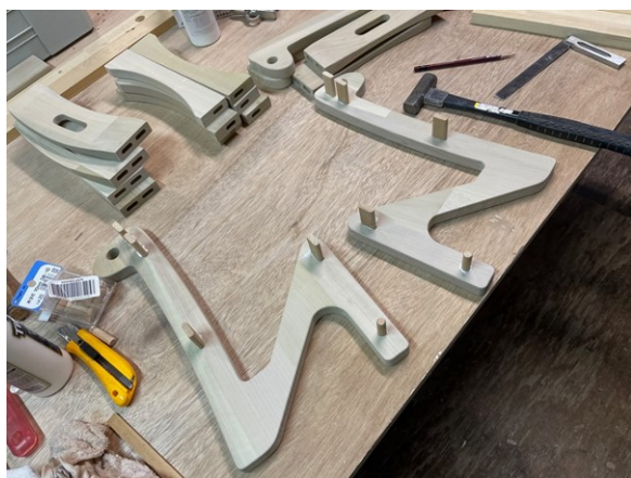
ほぞ穴加工、組立前の様子
