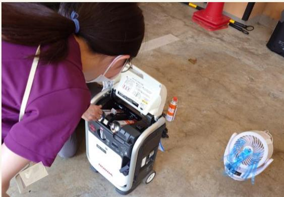
カセットボンベを燃料とする発電機を駆動します
