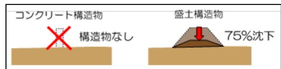
耐震性が無い施設の沈下や破壊の考え方
