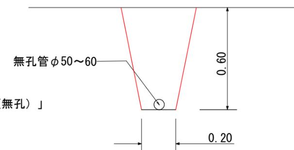
補助暗渠断面図 S=1/10
