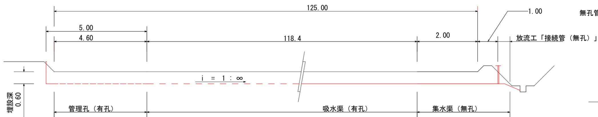
縦断面図（補助暗渠） S=1/50
