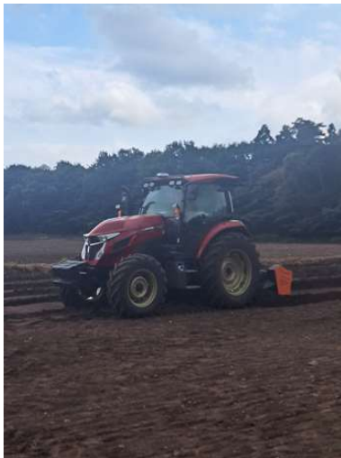
図 17 ストーンクラッシャーによる砕石作業①
