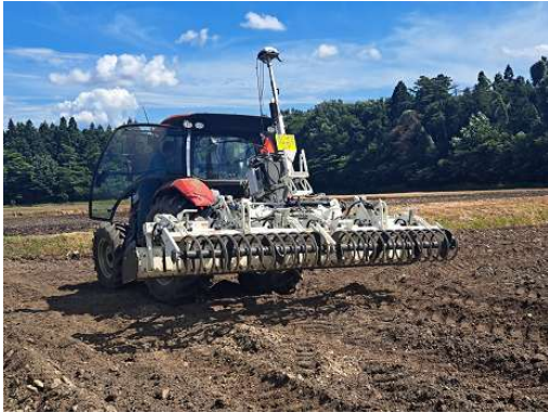
図 15 レーザーレベラーによる圃場の傾斜化①
