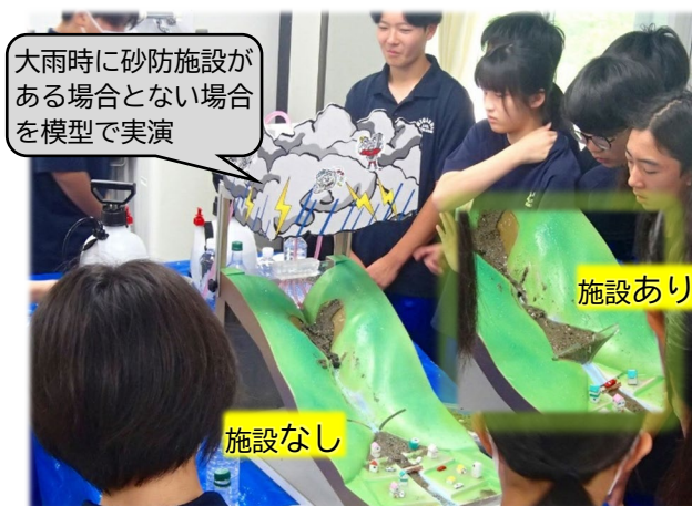
土石流模型での実験
